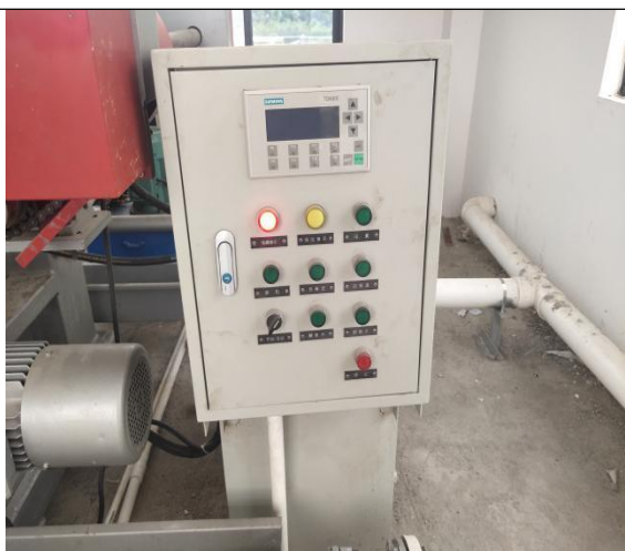
板框压滤机控制箱
